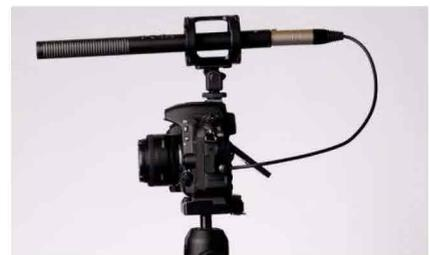
Verwendet man kurze Objektive mit kleinen Brennweiten, sollte man immer darauf achten, dass das 28 cm lange NTG4+ nicht etwa ins Bild ragt.
